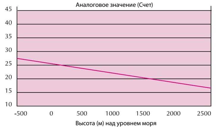
Рис.5 Типовая характеристика давления - ионизационный датчик XP95
