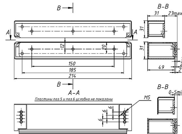
Рисунок 2 – Габаритно-установочные размеры комплекта МК AL-400SM-Shift
