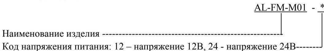
Пример записи при заказе: Электромагнитный замок AL-FM-M01-24 - Электромагнитный замок AL-FM-M01, напряжение питания 24В.
