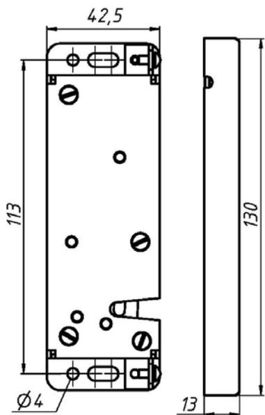
Рис.5 Корпус замка
