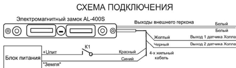
Рис.9 Схема подключения.
