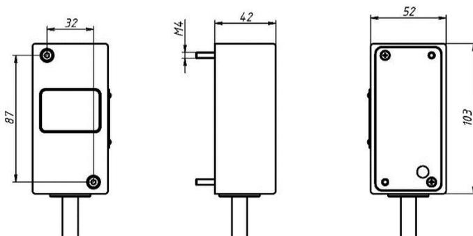
Рисунок 3 - Габаритно-установочные размеры считывателя AL-RD-05
