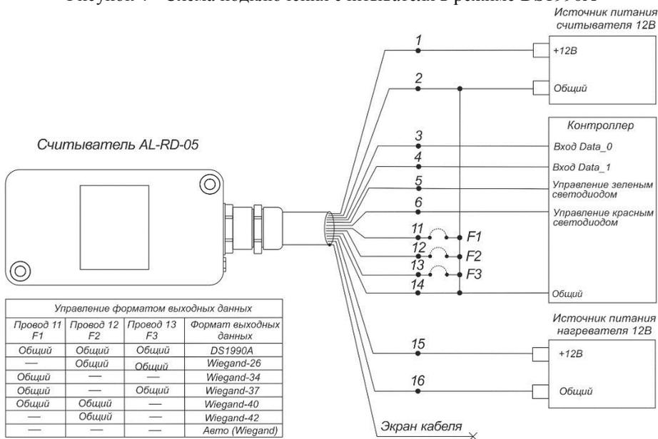
Рисунок 5 - Схема подключения счетчика в режиме Wiegand-26...42 или Авто.
