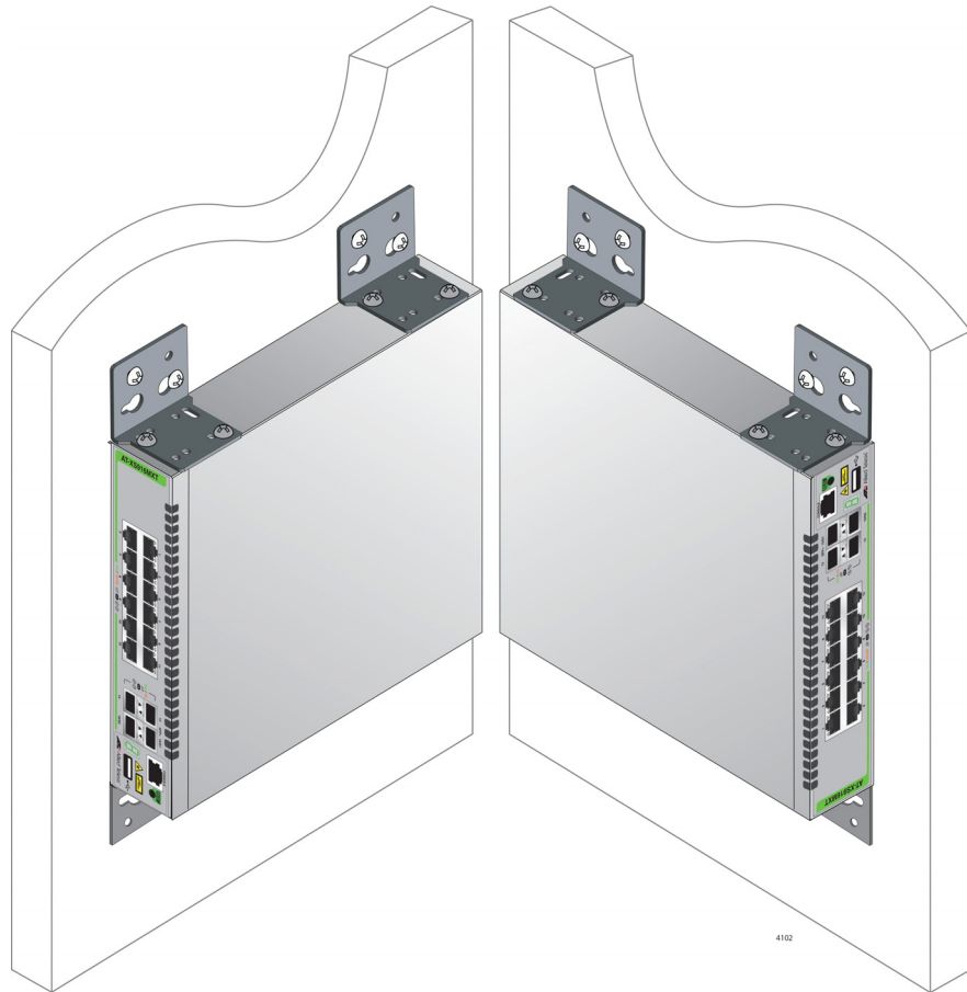
Рисунок 16. Возможные положения коммутатора серии XS916MX на стене
