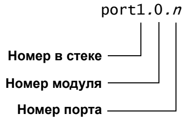
Рисунок 40. Параметр PORT в интерфейсе командной строки
