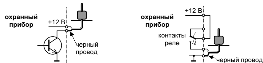
Рис. 1. Примеры монтажа передатчика
