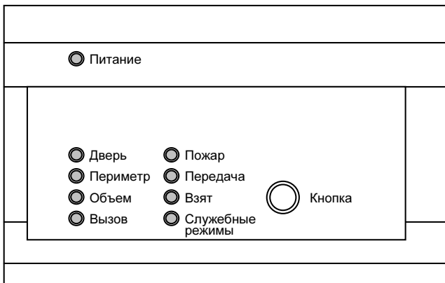
Рисунок 1. Внешний вид передатчика (надписи показаны условно)
