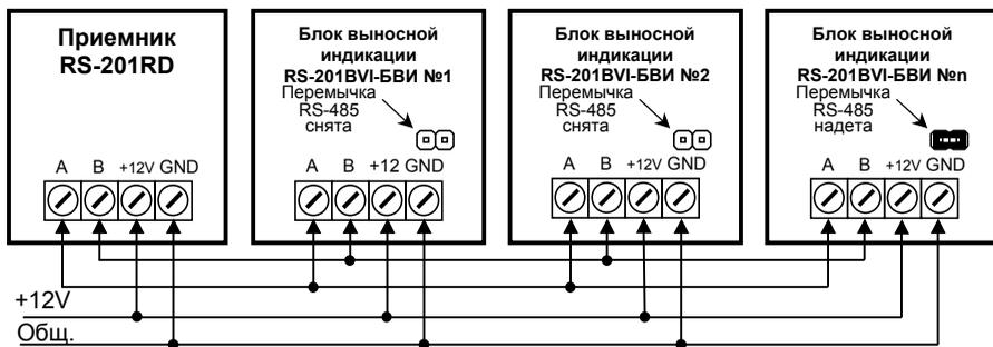
Рис. 1 – Пример подключения нескольких БВИ к приемнику
