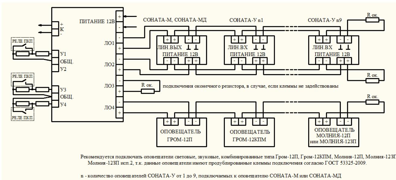
Рис.4 Схема подключения оповещателей по варианту №3 (п. 3.3.2 настоящего руководства по эксплуатации).
