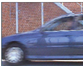
Черезстрочная развертка. Разница в 20 микросекунд между четными и нечетными линиями
