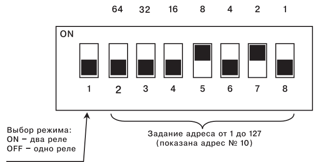
Рисунок 3 Назначение DIP-переключателей
