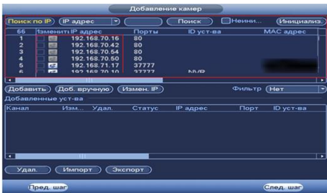
Рисунок 6.10 Настройка добавления камер по поиску в сети.
