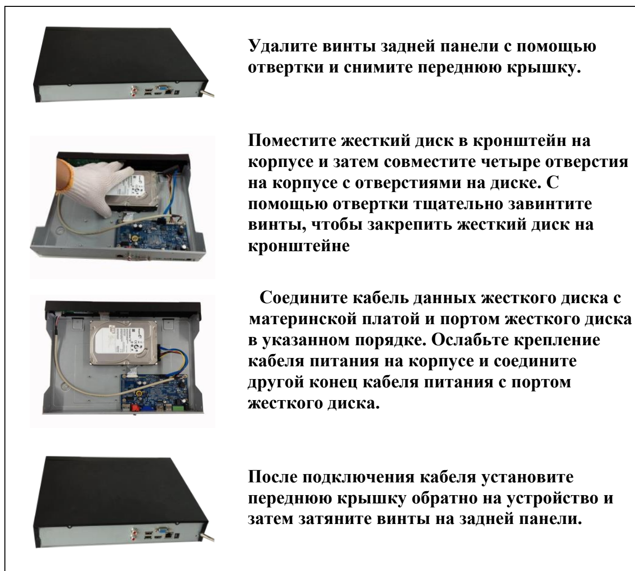
Рисунок 5.1 Установка жесткого диска
