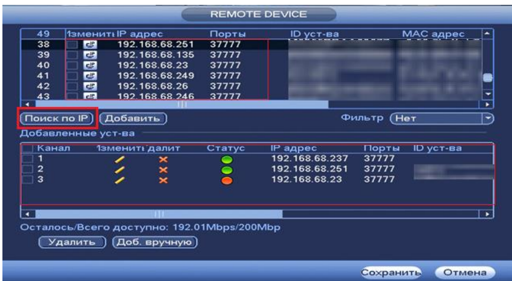
Рисунок 7.32 Настройка добавления камер по поиску в сети.
