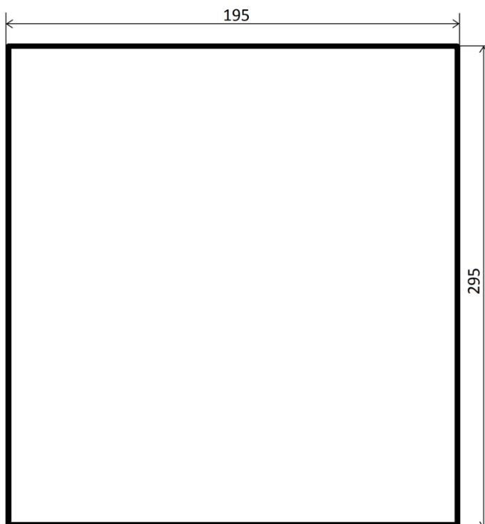
2) Установочные размеры РИП-12 исп.108 (РИП-12-5/17М7-V8) по задней стенке корпуса
