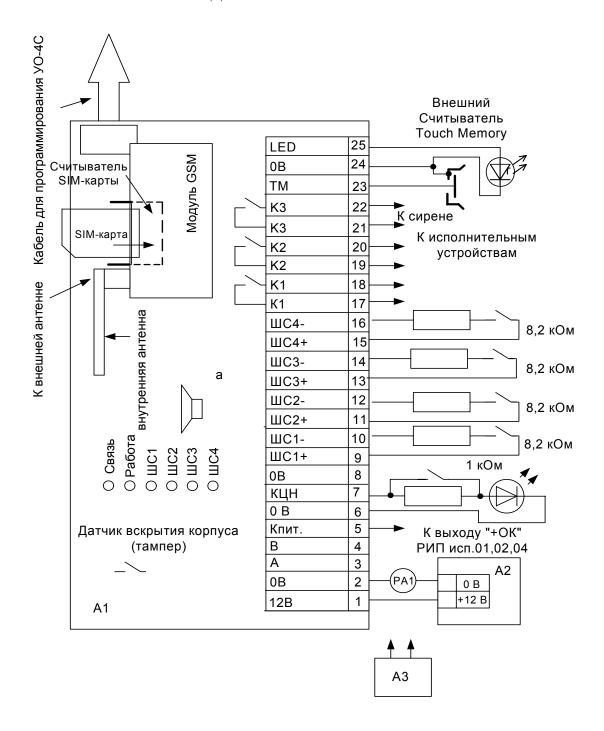
**А1** – устройство оконечное "УО-4С" исп. 02; **А2** – источник питания 12 В; 2А, например, "РИП-12", производства НВП "Болид"; **А3** – магазин сопротивлений; **РА1** – ампервольтметр, например, Ц4352.
