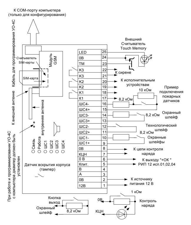
Реле К3 предназначено для подключения сирены
