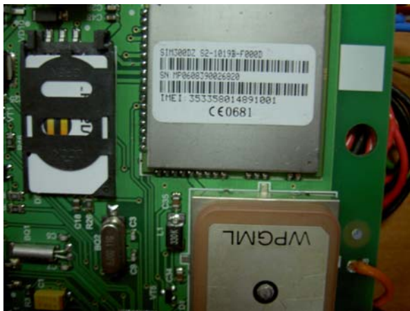
Рисунок 2 Расположение SIM-карты и GSM-модуля
