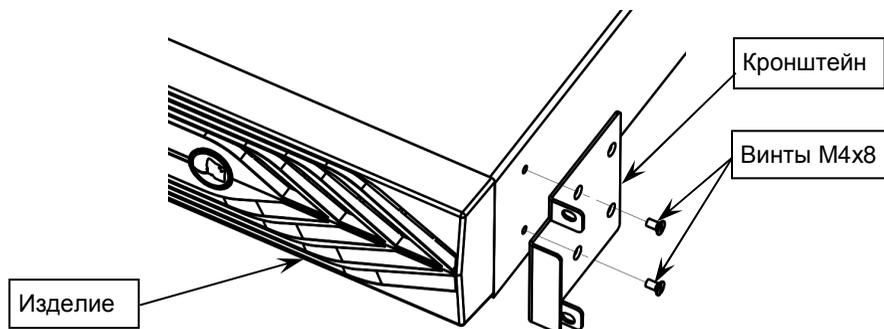
Рисунок 4 — Установка кронштейнов на корпус изделия
