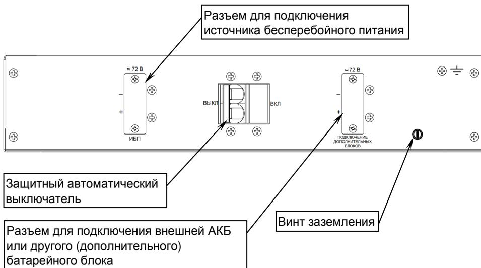
Рисунок 2 – Общий вид задней панели изделия
