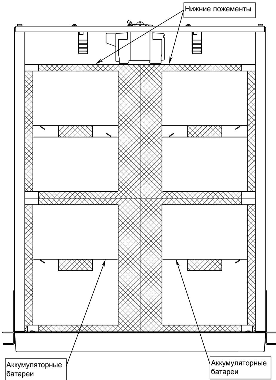
Рисунок 3 – Размещение аккумуляторных батарей в корпусе.
