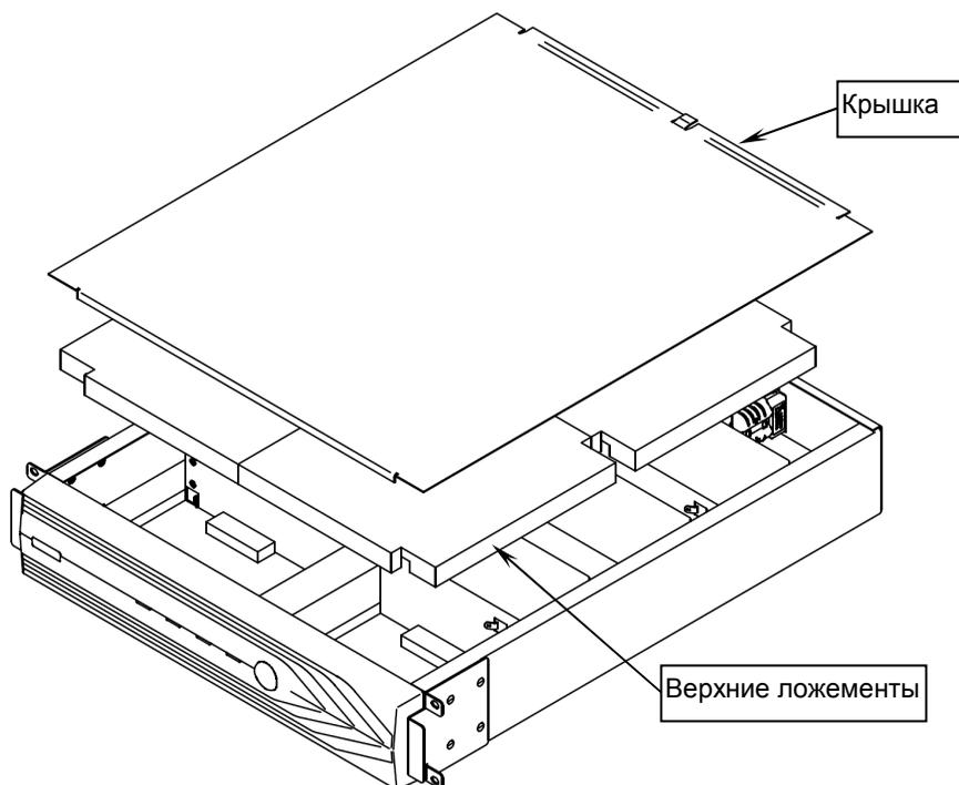
Рисунок 6 — Замена аккумуляторных батарей.
