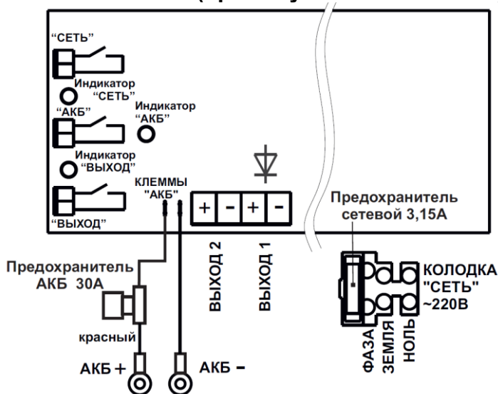
Рисунок 1 – Вид изделия с открытой крышкой (схема подключения)
