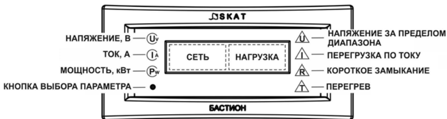
Рисунок 2 - Индикация и органы управления
