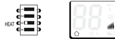
Если термостат управляет системой охлаждения, то переключатель устанавливается в положение COOL, на дисплее отобразится символ .
