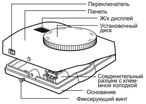
Монтаж ТЕРМОСТАТА производится следующим образом:
