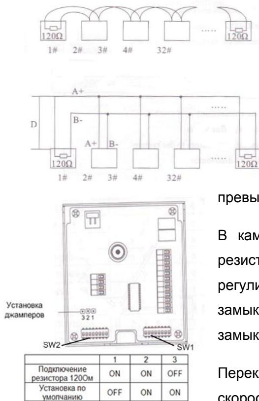
Управление поворотно-наклонным механизмом камеры и другими ее параметрами осуществляется по интерфейсу RS-485. Стандарт RS-485 требует, чтобы оборудование подключалось по цепочке, цепочка должна терминироваться резистором 120 Ом, как показано на верхнем рисунке. В простых случаях соединение может быть сделано, как показано на нижнем рисунке, при этом расстояние **D** не должно превышать 7 метров.
