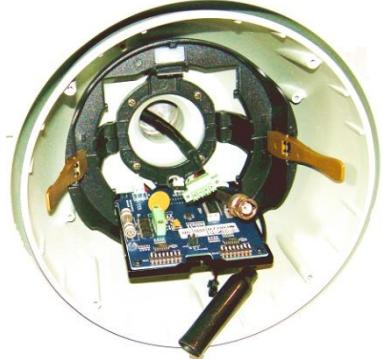
На плате расположены разъемы крепления кабеля, DIP переключатели, разъем видео.
