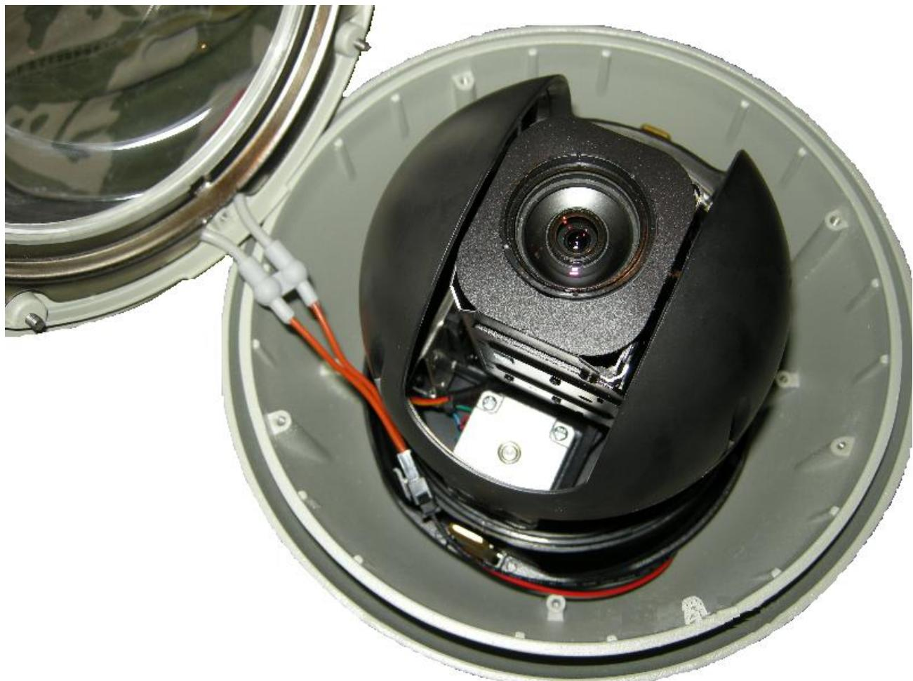
Аккуратно поворачивайте защитный купол по часовой стрелке таким образом, чтобы кабель и разъем обогревателя расположились ниже поворотной камеры, как показано на рисунке. Установите защитный купол и закрепите его с помощью 4-х винтов, имеющихся в куполе.
