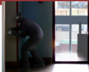
**Wide Dynamic Range.** Данная функция позволяет получить качественное изображение если в видимой области присутствуют перепады освещенности. Например, окно или фары автомобиля на заднем плане не позволяют рассмотреть лицо или другой объект на их фоне. Функция WDR даже в этих условиях позволяет получить четкое и ясное изображение без засветок и искажений.
