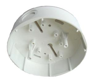
Дополнительное основание извещателя MSC 420 было специально разработано для использования с кабелями питания в защитных каналах с поверхностным монтажом и имеет 2 противоположных отверстия, диаметр каждого из которых составляет 20 мм, и 2 дополнительных входных отверстия, диаметром около 28 мм.
