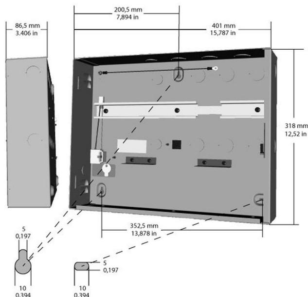
Корпус предназначен для установки AMC2, источника питания (AMC PBC60) и двух батарей.
