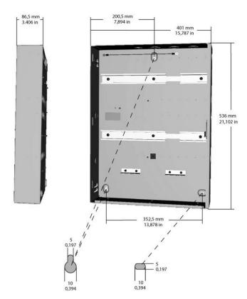
Корпус предназначен для установки двух устройств (AMC2 или AMC2 xI-xO-EXT), двух источников питания (AMC PBC60) и двух батарей.
