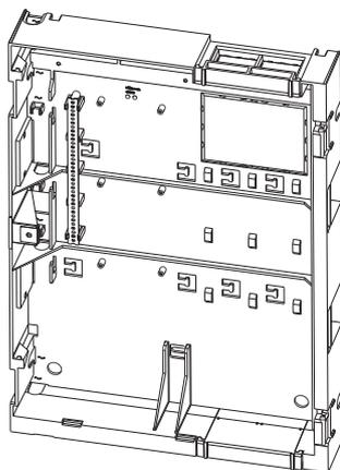
Большая монтажная рама требуется для следующих монтируемых в раму корпусов:
