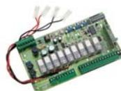
Плата блока управления (с расширенным набором функций) двумя приводами с разъемом для установки радиоприемника CAME.
