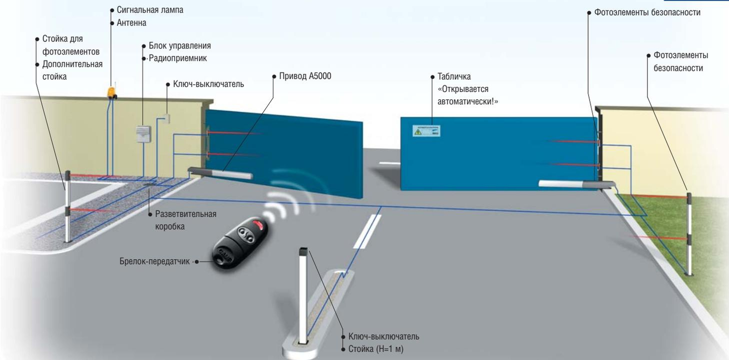
Учитывая эксплуатационные риски, возникающие при использовании автоматических ворот, необходимо устанавливать инфракрасные или электромеханические устройства безопасности.
