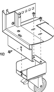
Ролики СТК-ШТК-Э непосредственно ввинчиваются в имеющиеся резьбовые отверстия M10 вместо винтовых опор.
