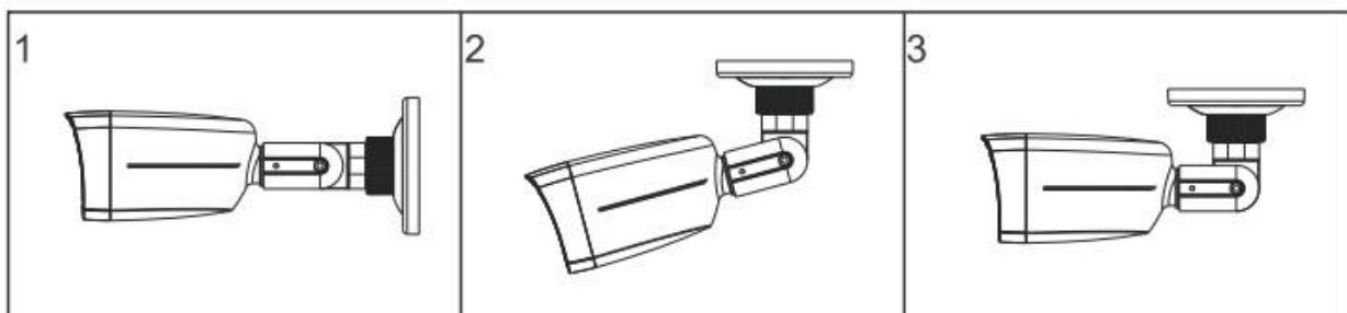
1. Установите камеру на нужное место и закрепите её при помощи винтов или саморезов.
