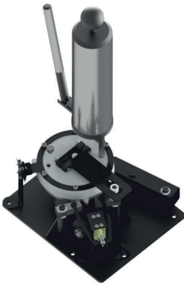
Рисунок 12.3.3 – Доливка демпферной жидкости.
