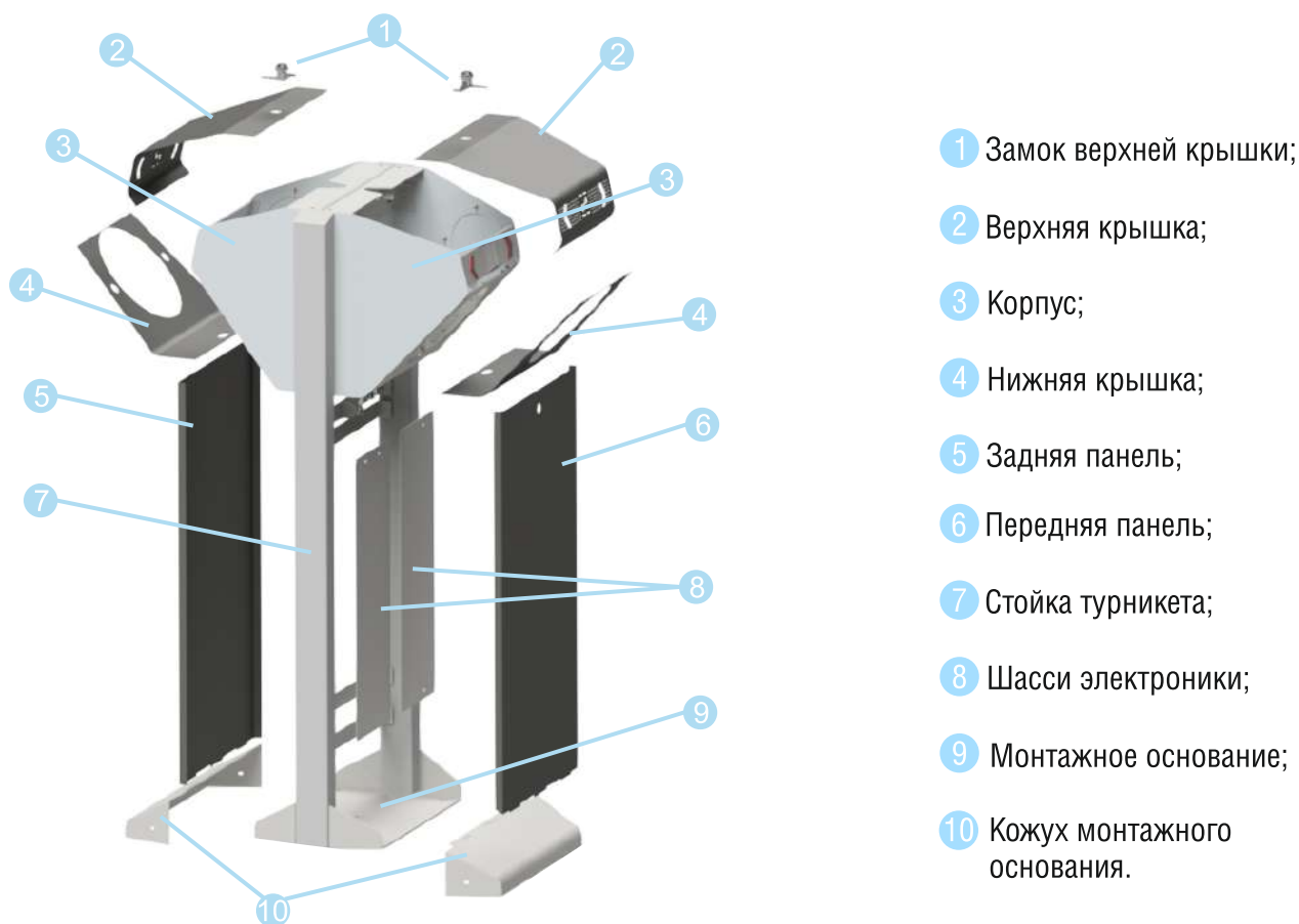
Рисунок 6.1.1 Устройство корпуса турникета
