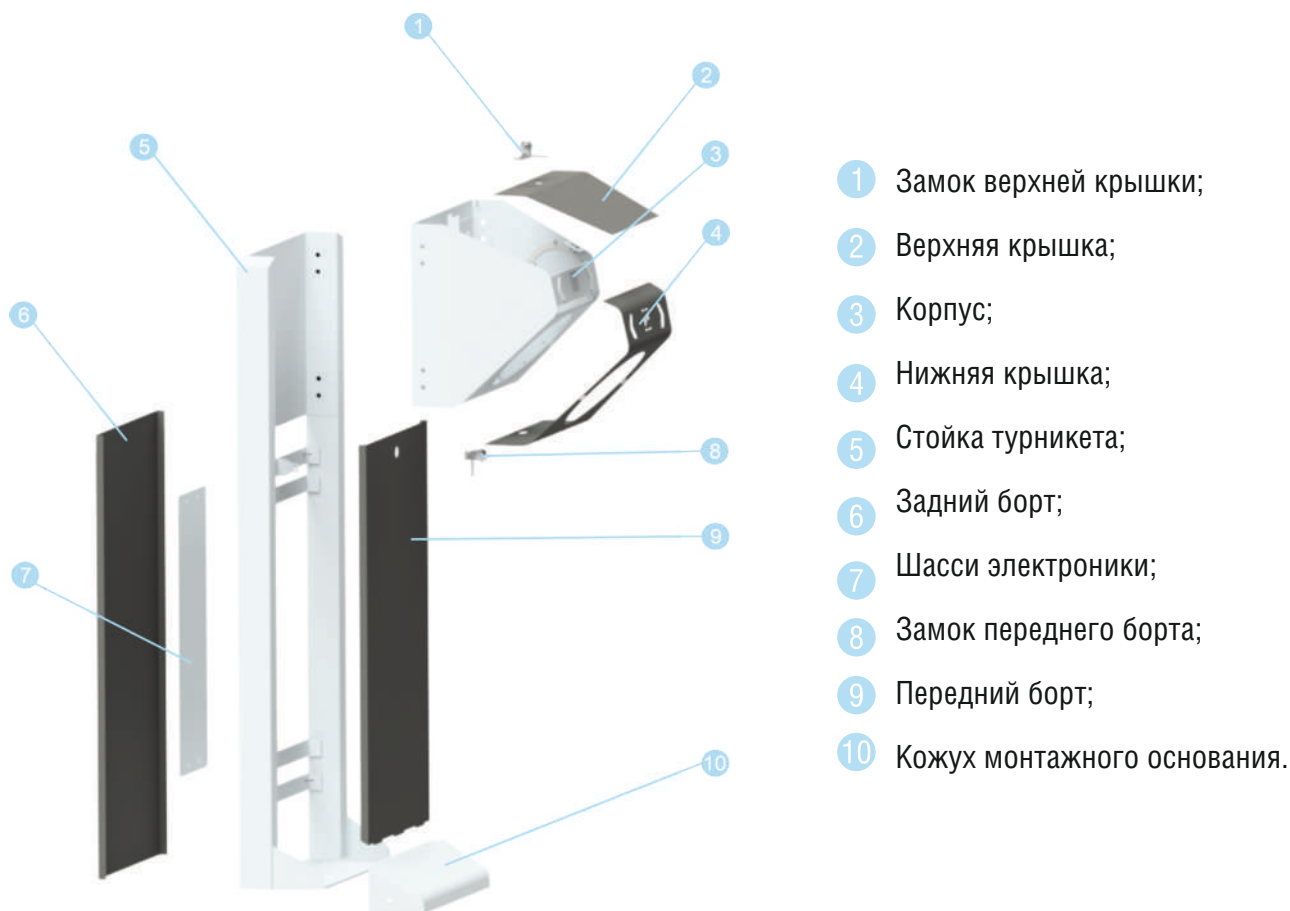
Рисунок 6.1.1 Устройство корпуса турникета
