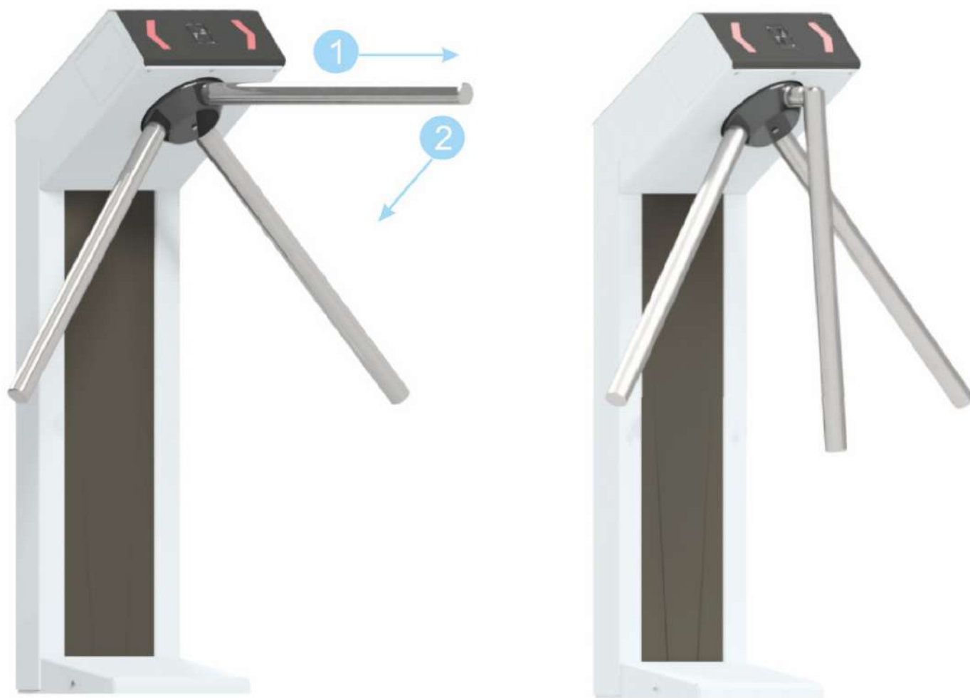
Рисунок 6.5.3 - Принцип работы планок «Антипаника».
