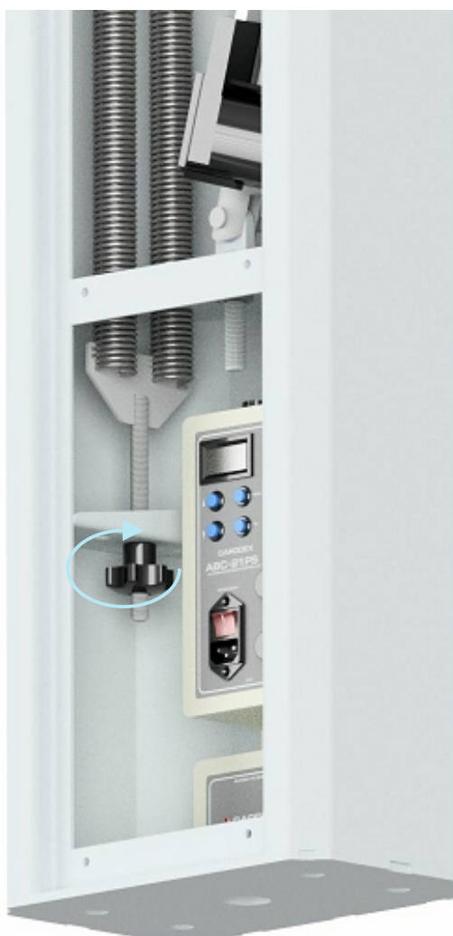
Рисунок 21 – Натяжение балансировочных пружин
