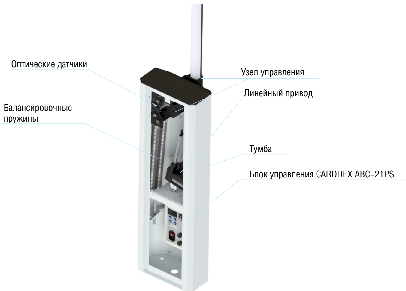
Рисунок 2. Внешний вид и состав шлагбаума
