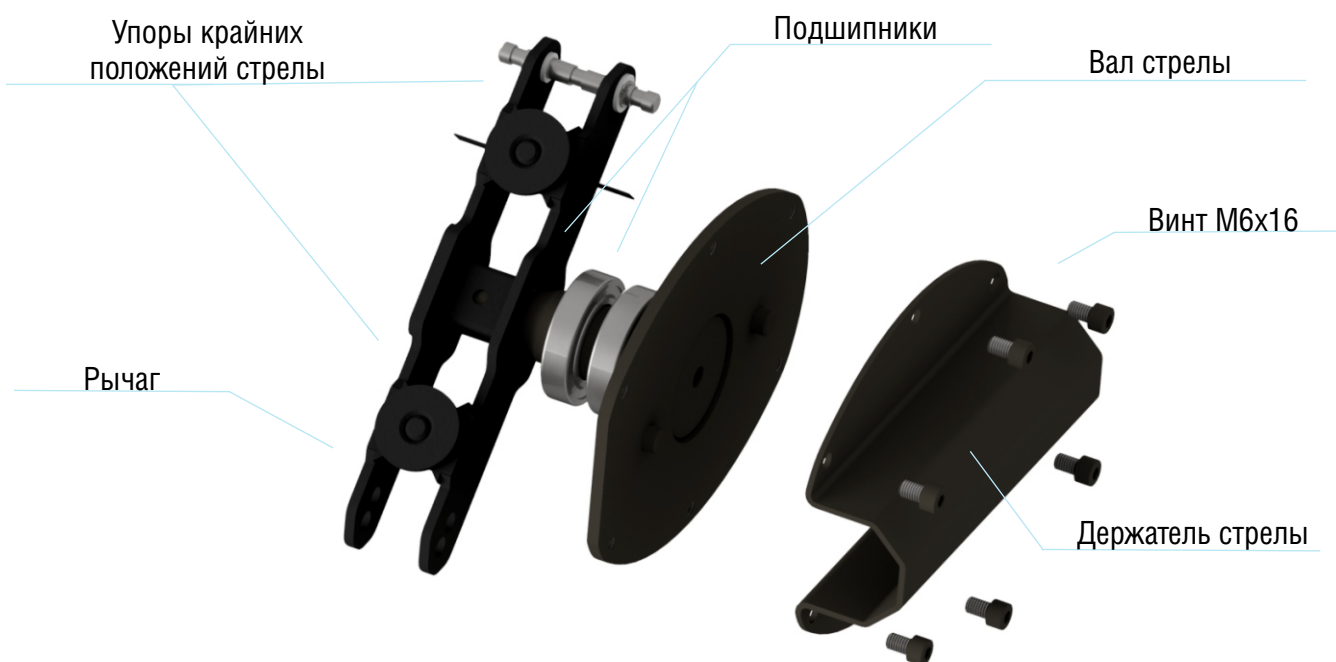
Рисунок 4. Узел крепления и управления стрелой
