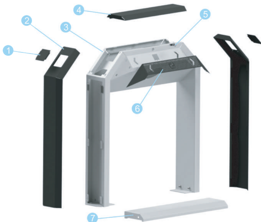
Рисунок 6.1.1. – Элементы корпуса турникета «STR-03».
