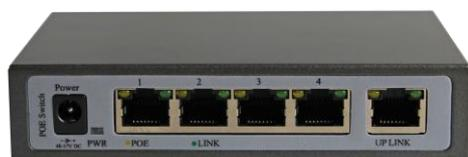
PoE коммутатор 4xRJ45 PoE 10/100 до 15Вт и 1xRJ45 Uplink 10/100. Неуправляемый. Производительность до 0.744Mpps. Store-And-Forward, Auto-negotiation, Flow Control, Full duplex. Бюджет PoE до 65Вт. Питание DC 48~57В (блок питания 52В / 1.25А в комплекте), потребление до 70Вт. Температурный диапазон 0°С ~ +55°С, IP20, вес 780г, размеры 125x73x27мм. Металлический кожух.
