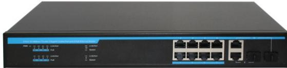
PoE коммутатор для CCTV. 8xRJ45 PoE 10/100 до 30Вт и 2xSFP совмещенных с 2xRJ45 Uplink 10/100/1000. Неуправляемый. Производительность 5.6Gbps. Store-And-Forward, Auto-negotiation, Flow Control, Full duplex. Бюджет PoE до 150Вт. Питание AC 220В / 50Гц (встроенный блок питания), потребление до 180Вт. Температурный диапазон 0°C ~ +45°C, IP20, вес 2800г, размеры 330x200x44мм. Металлический 13" кожух (в комплекте 19" скобы, кабель питания 220В).
