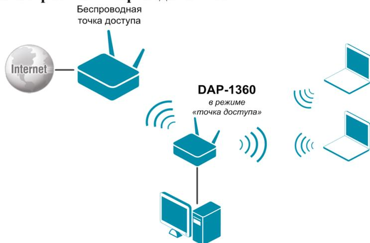
Устройство DAP-1360 в режиме «точка доступа» подключено к точке доступа по беспроводному соединению. Компьютеры подключаются к DAP-1360 через проводное или беспроводное соединение. Необходимо настроить одни и те же параметры беспроводного соединения (название сети, параметры шифрования, канал) для DAP-1360 и удаленной точки доступа.
