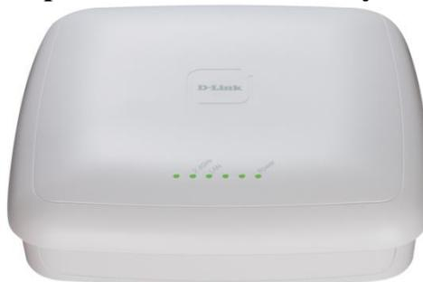
DWL-3600AP – унифицированная точка доступа 802.11n Wi-Fi, разработанная для развертывания сетей бизнес-класса. Гибкая в управлении и поддерживающая передачу данных на высокой скорости, данная точка доступа обеспечивает легкую интеграцию в существующую сетевую инфраструктуру, которая в дальнейшем может быть расширена. Точка доступа может быть выполнена в корпусе класс Plenum (DWL-3600AP/A1A) или в обычном пластиковом корпусе (DWL-3600AP/A1A/PC).
