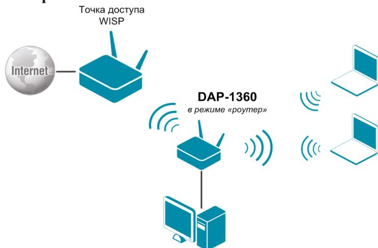
Устройство DAP-1360 в режиме «роутер» подключено к точке доступа беспроводного Интернет-провайдера (WISP) по беспроводному соединению. Компьютеры подключаются к DAP-1360 через проводное или беспроводное соединение. Необходимо настроить один и тот же канал беспроводного соединения для DAP-1360 и точки доступа WISP. Другие параметры беспроводной сети DAP-1360 не зависят от настроек точки доступа WISP. Кроме того, для DAP-1360 необходимо настроить WAN-соединение.
