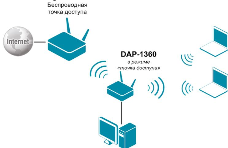
Устройство DAP-1360 в режиме «точка доступа» подключено к точке доступа по беспроводному соединению. Компьютеры подключаются к DAP-1360 через проводное или беспроводное соединение. Необходимо настроить один и тот же канал беспроводного соединения для DAP-1360 и удаленной точки доступа. Другие параметры беспроводной сети DAP-1360 не зависят от настроек удаленной точки доступа.
