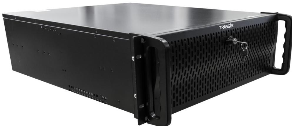
**TRASSIR QuattroStation** – сетевой видеорегистратор для систем IP-видеонаблюдения высокой мощности для записи большого числа каналов с использованием видеоаналитики. Запись, воспроизведением и отображение до 64-х каналов IP-видеокамер любого поддерживаемого производителя.
