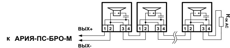
*Рис. 1а. Схема соединений 1, 2, 3 и 4 речевых оповещателей АРИЯ-10 и АРИЯ-10П.
