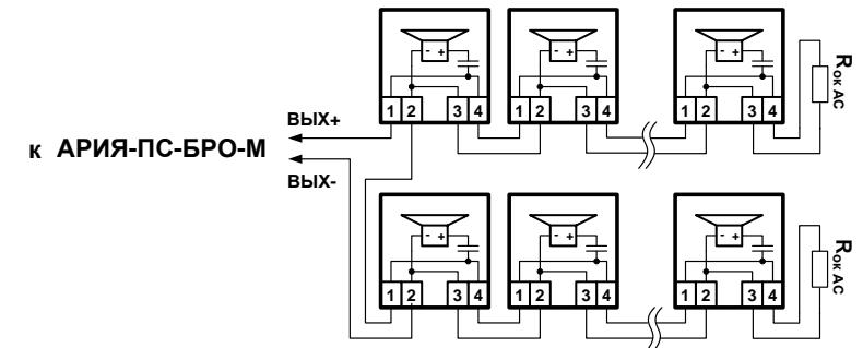
*Рис. 1б. Схема соединений 4, 6, 8, 10 и 12 речевых оповещателей АРИЯ-10 и АРИЯ-10П.
