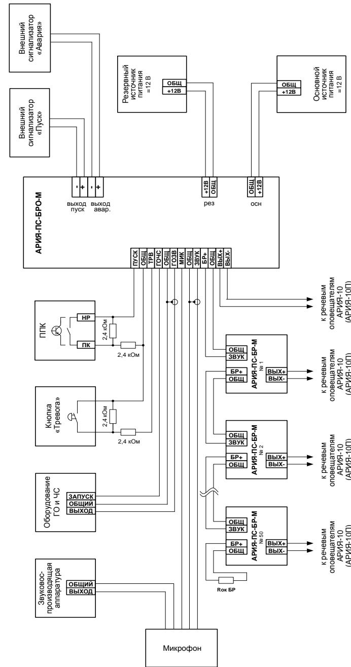
Рис. 2. Схема соединений блока речевого оповещения АРИЯ-ПС-БРО-М
