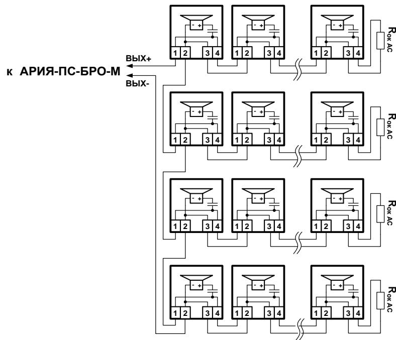
Рис. 1g. Схема соединений 16, 20, 24, 28, 32, 36, 40, 44 и 48 речевых оповещателей АРИЯ-10 и АРИЯ-10П.
