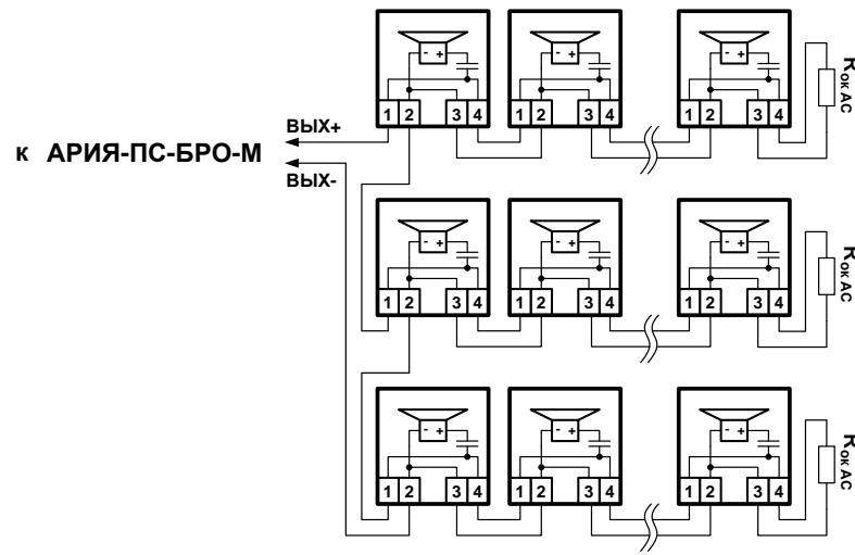
Рис. 1e. Схема соединений 9, 12, 15, 18, 21, 24 и 27-ми речевых оповещателей АРИЯ-10 и АРИЯ-10П.
