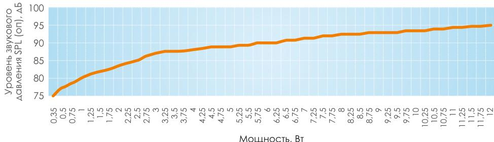
Рис. 3. Зависимость уровня звукового давления речевых оповещателей от проводимой мощности
