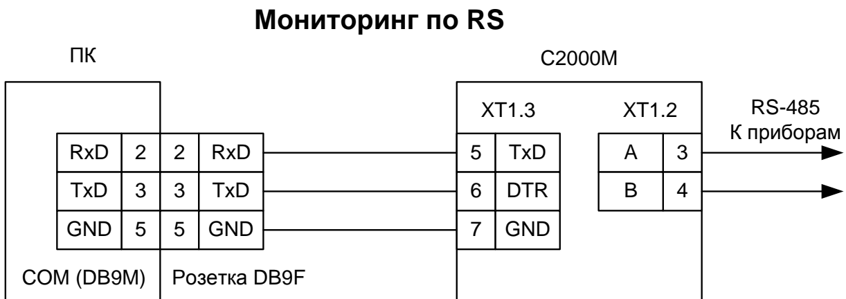
Рис. 42 – Подключение пульта C2000(M) в режиме мониторинга по RS
