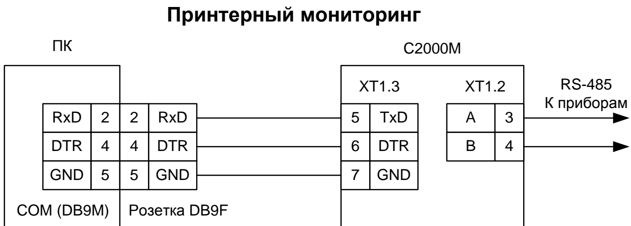
Рис. 43 – Подключение пульта С2000(М) в режиме принтерного мониторинга
