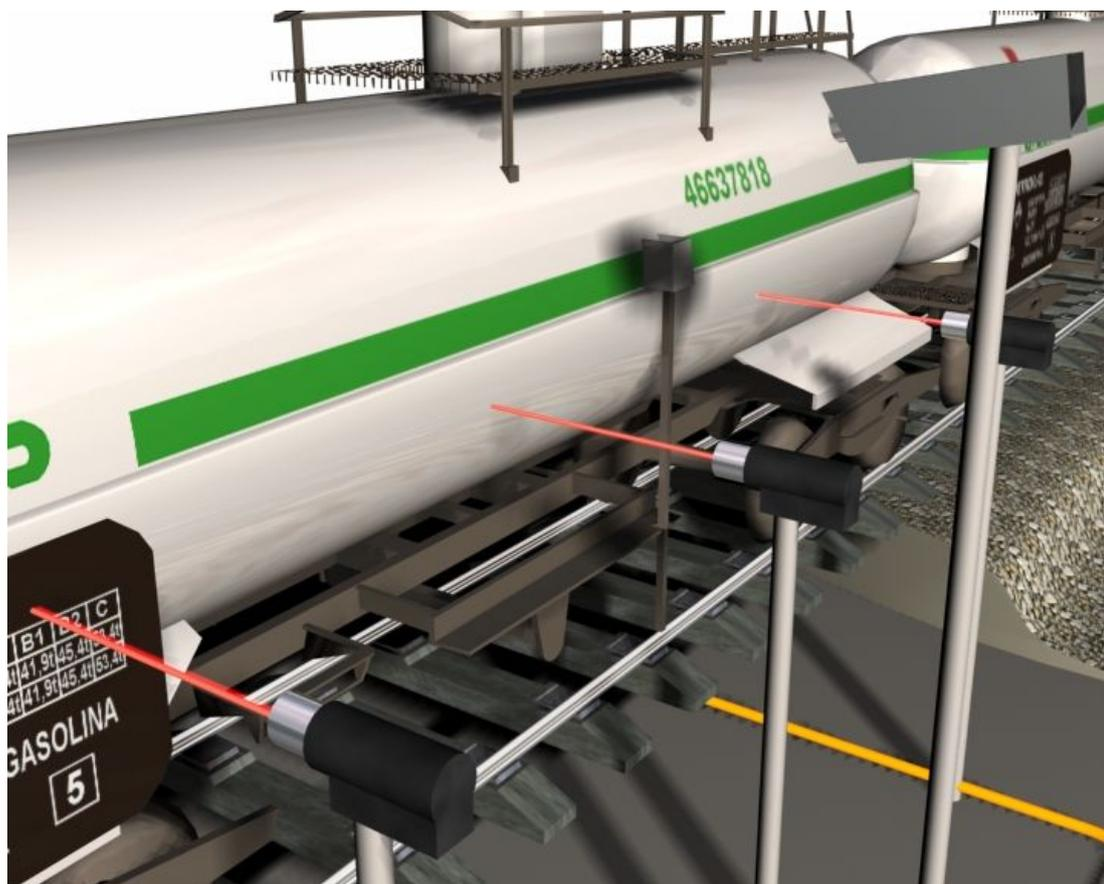
Рис. 5 Схема построения системы с внешним счётчиком на базе контроллера Elsys
