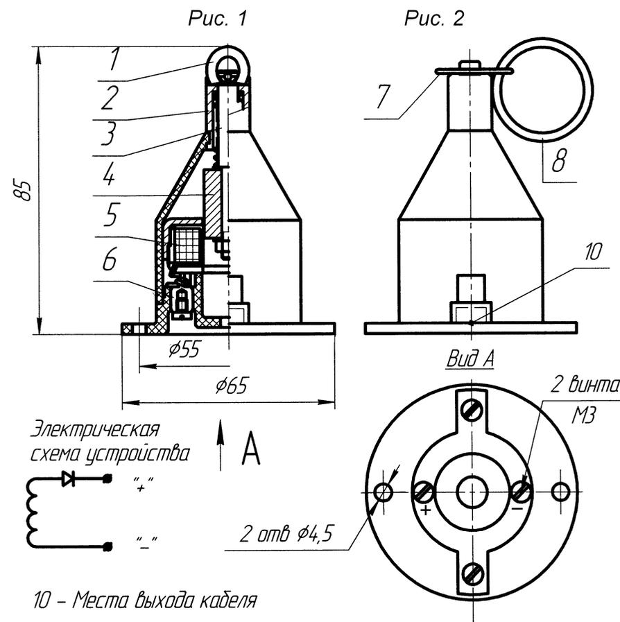
5.2. При превышении температуры окружающей среды срабатывает элемент термочувствительный (1), который освобождает в корпусе (2) подпружиненный шток (3). На штоке закреплен магнит (4), который проходит через индукционную катушку (5) и вырабатывает в ней импульс, через контакты (6), поступающий по соединительным проводам на побудительную систему установки пожаротушения и/или средства сигнализации.
