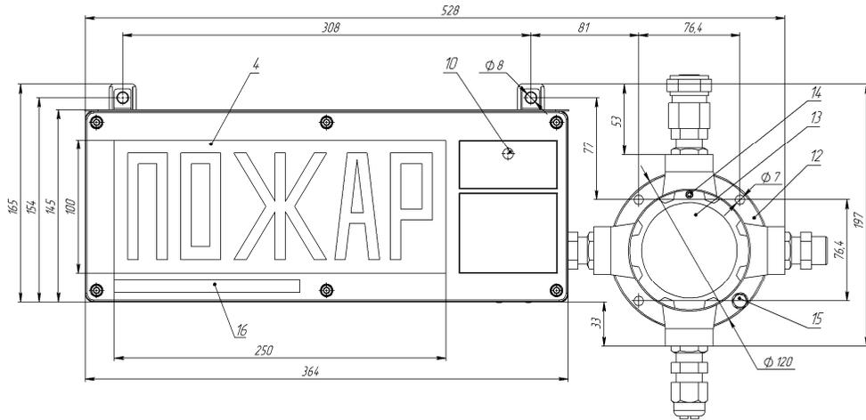
б) Внешний вид оповещателя ЭКРАН-KKB с постоянно присоединенной внешней взрывозащищенной клеммной коробкой
