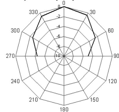
**Рисунок 3.** Диаграмма направленности звука ЭКРАН со звуковой функцией.
