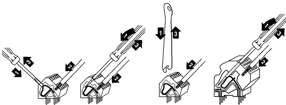
Для подключения проводников в клеммы:
