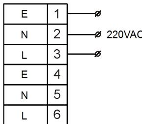
\* Клемма «E» соединена с корпусом оповещателя
