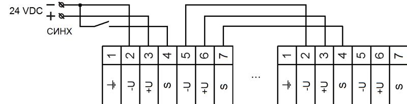
Синхронизация оповещателей осуществляется отрицательными импульсами с периодом следования (T) не менее 1 с, длина импульсов синхронизации должна быть не более 0,8T.
