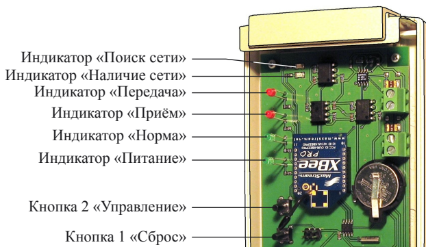
Рис. 13. Органы управления и индикации РС-К и РС-М
